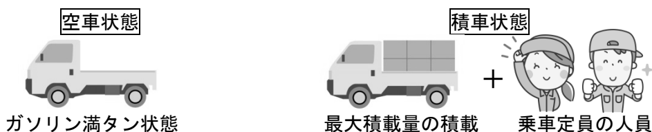
▼図 2-6 空車状態と積車状態
