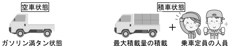
▼図 2-6 空車状態と積車状態
